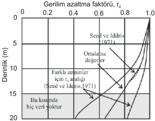
Şekil 4. Gerilim azaltma faktörünün derinlikle olası değişimi (Youd vd., 2001)
