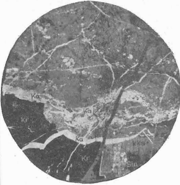
Şekil 39: Silisleşmiş kayaçların mikroskofta görünüşü (Num. No: 273a; P.I. X6). Ks: Kriptokristalli silis; Ka: Kromit; Sin: Zinober. Figure 39: Microscopic view of silicified rocks. (Sample No: 273a; Pol. light, X6) Ks: Cryptocrystalline silica; Ka: Quartz; Kr: Chromite; Sin: Cinnabar.
