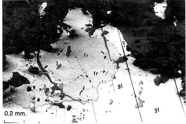
Şekil 3: Galen (gl) ve frayberjitin (fr) mikroskoptaki görünümü Figure 3: Microscopic view of galena (gl) and freibergite (fr)
