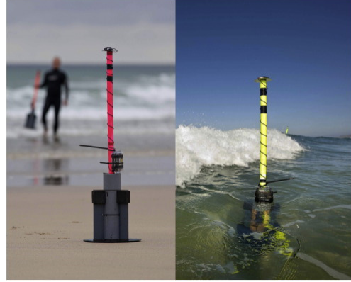
Şekil – 3: Çeken akıntı ölçümünde kullanılan GPS ile donatılmış sürüklenen cisimler (Scott vd, 2016).
