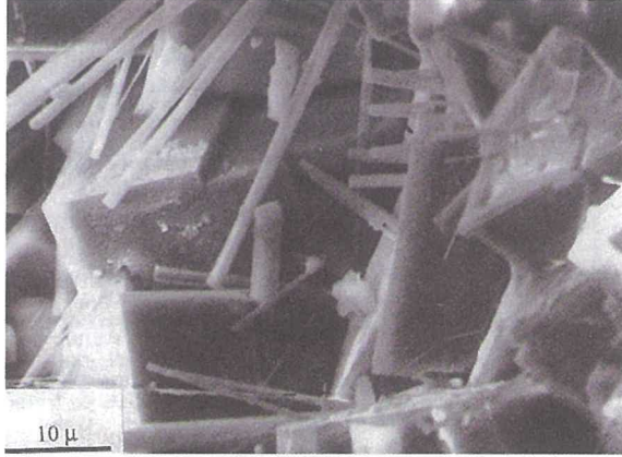
Şekil 2.7. Tuzköy yerleşim alanındaki tüften alınan örneğin SEM görüntüsü (şabazit-eriyonit=eriyonit kristalleri iğnemsî şekilde olanlar) (Temel ve Gündoğdu, 1996)
