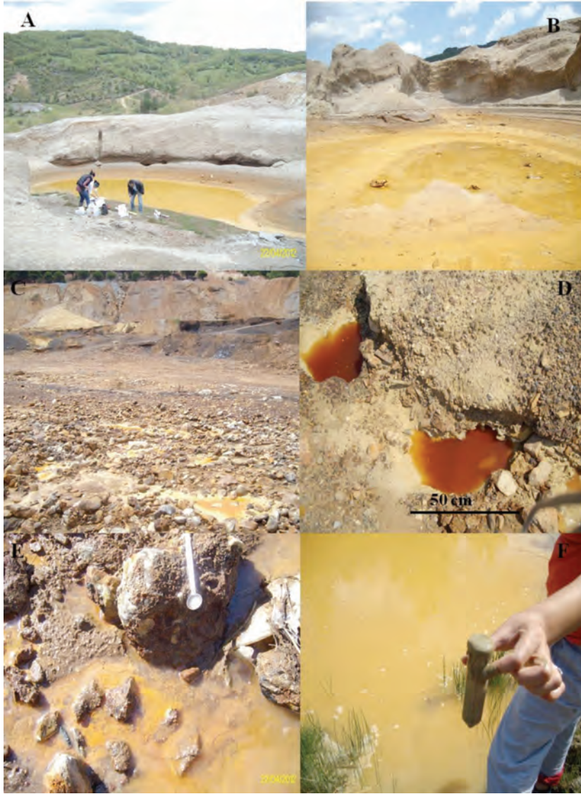
Şekil 3. A ve B: Atıkların üzerinde oluşan asidik göletler ve yapılan örnekleme çalışmalarından görüntü; C ve D: Flotasyon ve izabe atıkları içinde oluşan asidik göletler; E ve F, Asidik göletlerden mikrobiyolojik çalışmalar için örnek alımı.
