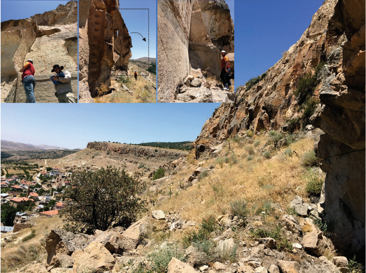
Şekil 5. Kaynak zonundaki dik süreksizlikler ve potansiyel duraysız bloklar.
