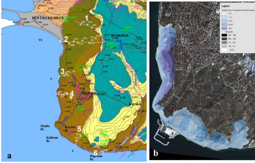
Şekil 1. İstanbul’ da Büyükçekmece Küçükçekmece Gölleri Arasının; a) Mühendislik Jeolojisi Modeli ve b) Yeraltısuyunun Yüzeiden Derinlik Haritası
