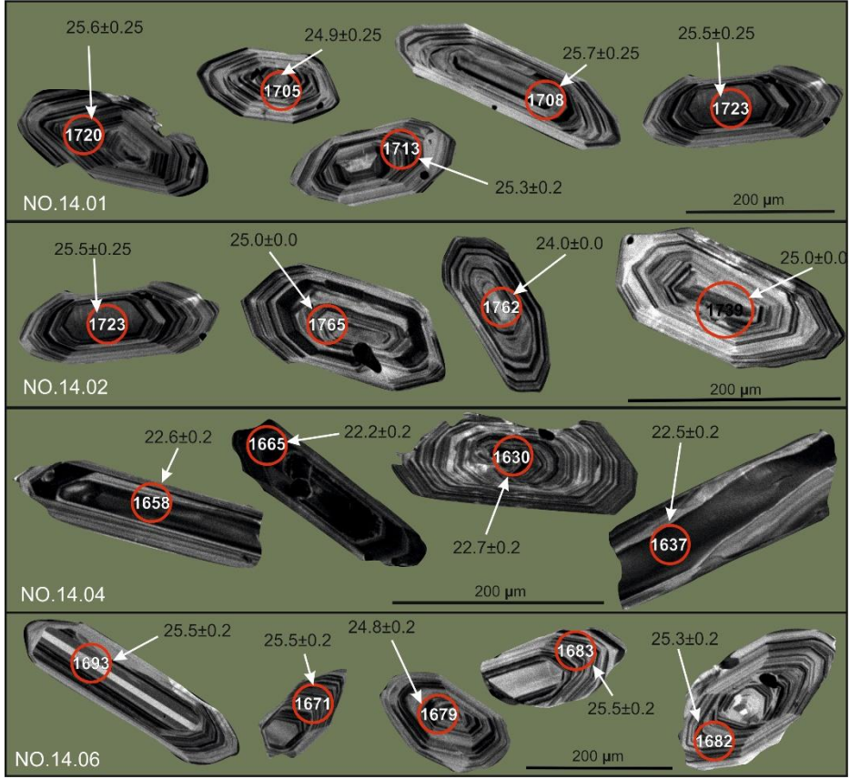
Şekil 1: Analiz edilen tuf örneklerinde yaşlandırılan temsili zirkonların katodoluminesans görüntüleri. Kırmızı daireler analiz edilen noktaları, daireler içindeki rakamlar ise analiz numarasını gösterir. Elde edilen yaşlar hata payları ile birlikte milyon yıl cinsinden gösterilmiş olup ^{206}\text{Pb}/^{238}\text{U} yaşlarına karşılık gelmektedir.
