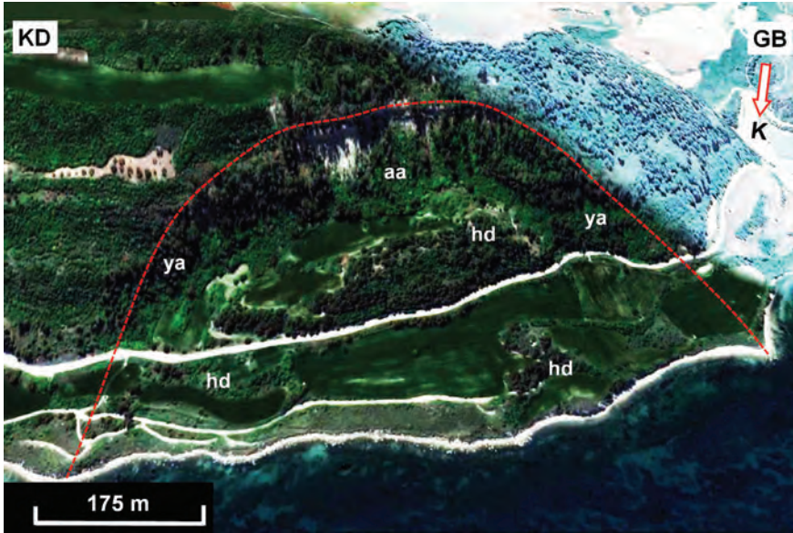
Şekil 15. Erenköy'ün 2.5 km batısında kısmen aşındırılmış fossil heyelan. Heyelanın ayak ve topuk kısmı denizin içine uzanır. Kırmızı noktalı çizginin alt kesimi ana aynayı, "ya" yan aynayı, "hd" ise heyelan döküntüsünün yaygın bulunduğu alanları göstermektedir.
