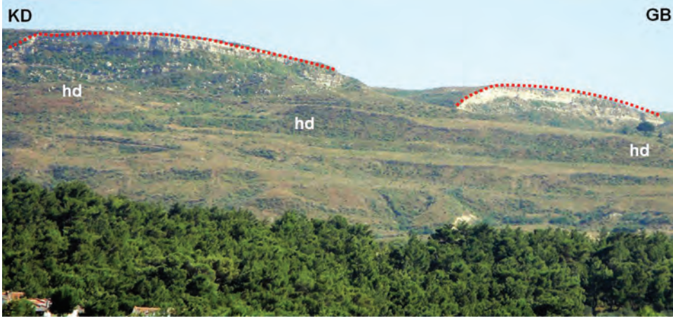
Şekil 11. 535 m. ve 345 m. uzunluğunda taç kırığı olan iki heyelanın kuzeybatıdan görünümü. Kırmızı noktalı çizginin alt kesimi ana aynayı, “hd” ise heyelan döküntüsünün yaygın bulunduğu alanları göstermektedir. Lokasyon için Şekil 6 ve 7 ye bakınız.
