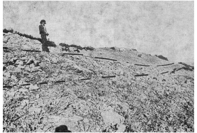
Şekil 14. Dernek'in kuzeydoğusunda yamaçta meydana gelen kabarma. Ortalama 60 cm kabarmasının meydana geldiği zon çizgiler arasına alınmıştır.
