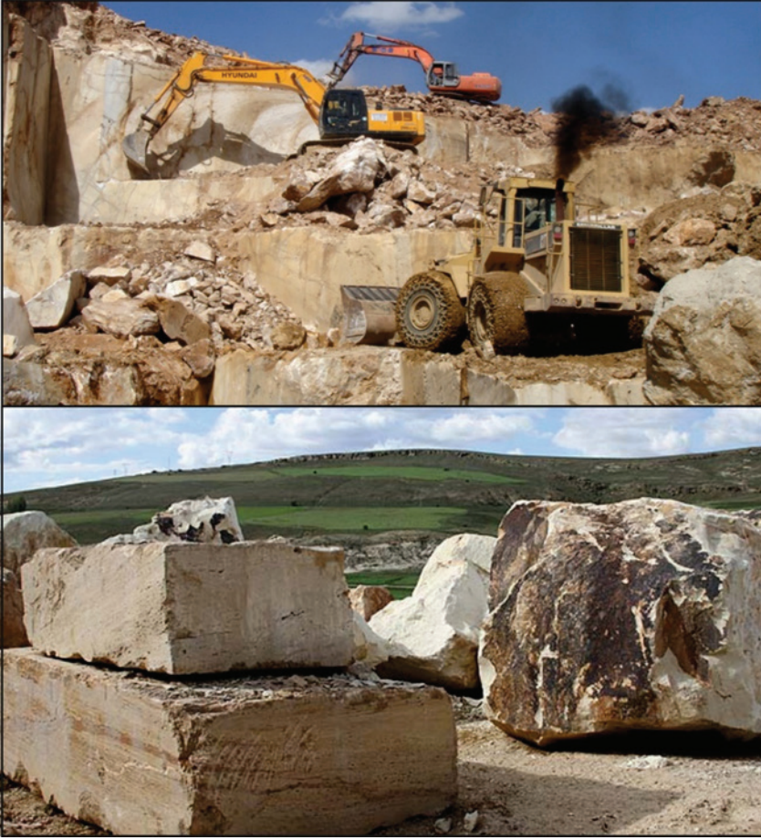
Şekil 3: Bayburt Taşı'nın çıkarıldığı ocak ve tüfit blokları (6).
