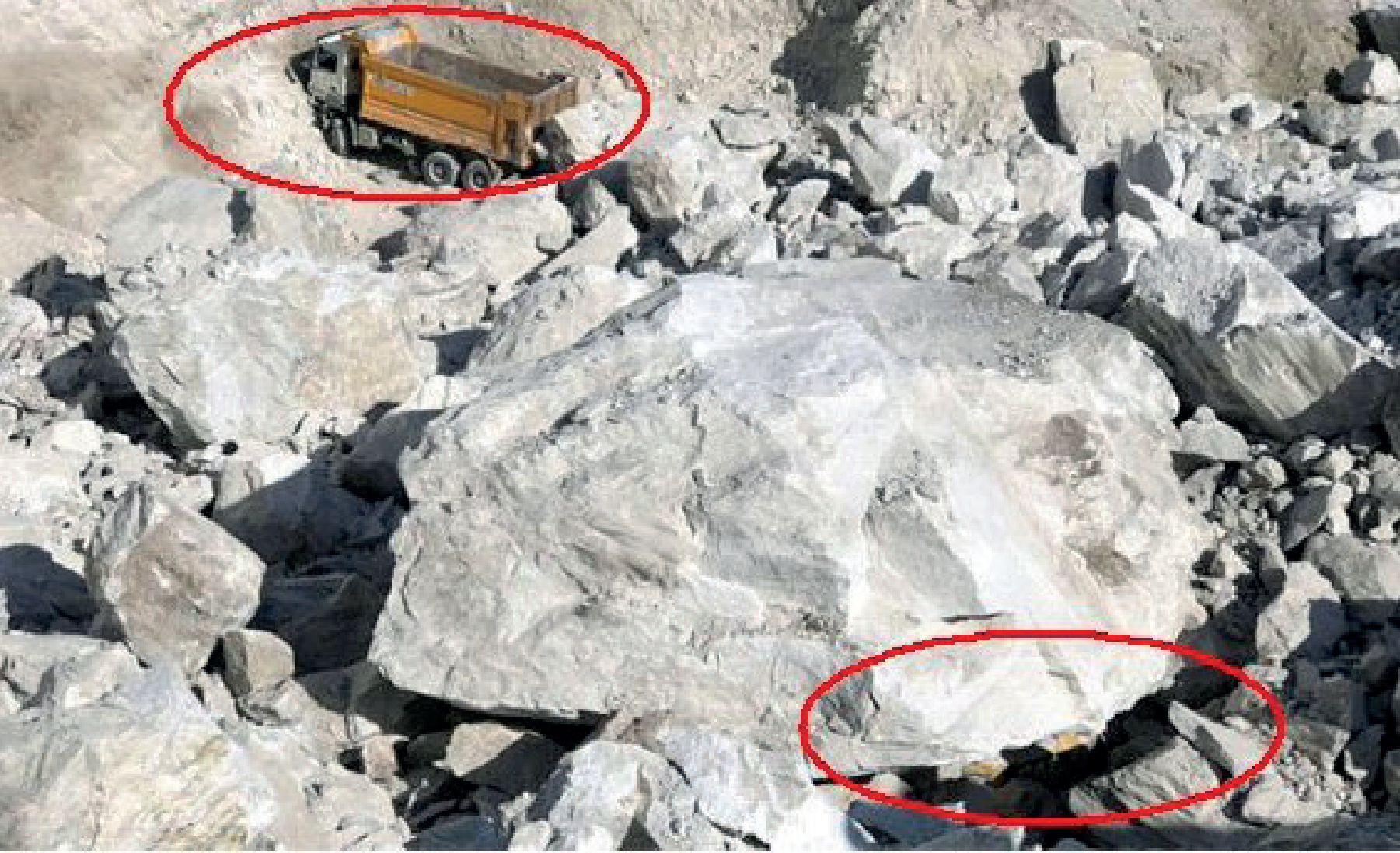
Şekil 2: Kayma düzlemi boyunca hareket eden kayaların altında kalan iş makineleri
