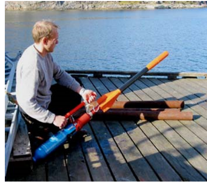
Şekil – 6: Yeni tip savlo atma aleti
