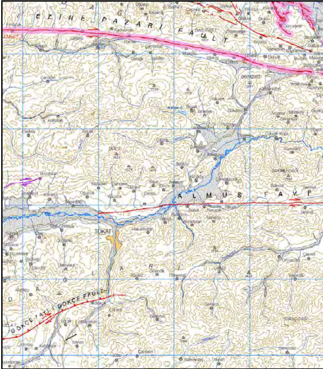
Şekil 3. TDFH na göre Tokat ve yakın çevresindeki diri faylar (kırmızı renkli kalın çizgiler, Emre vd., 2013 ten alınmıştır). Oklar fayların hareket yönünü, gri noktalı alanlar alüvyon birimlerini göstermektedir.
