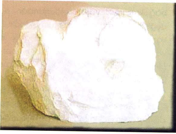
Boraks ( \text{Na}_2\text{B}_4\text{O}_7 \cdot 10\text{H}_2\text{O} ) Rengi: Renksiz-Beyaz Kristal sistemi: Monoklinik Sertlik: 2-2,5 Özgöl Ağırlık: 1,71 g/cm 3
