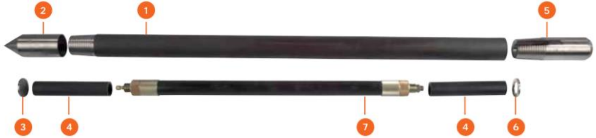
Şekil.20 \phi 63\text{mm} Menard yarıkli muhafaza (slotted tube) borusu [1] ile \phi 44\text{ mm} prob [7] (AX prob uzunluğu 84cm, BX prob 70cm) (Apegeo 2010-2011katolog)
