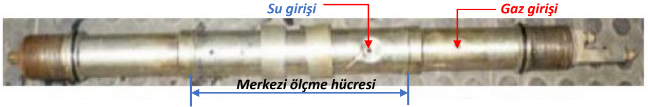
Probun üzerindeki delikler membran ve kılıfın tamamen söküldüğündeki (çıplak) görünümü (1)
