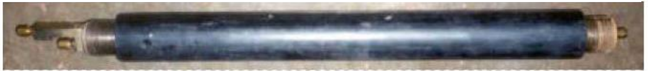
Koruyucu kaplama yerleştirme (kılıf), 3 mm lastik içinde (4) dış bilezikler takılmamış
