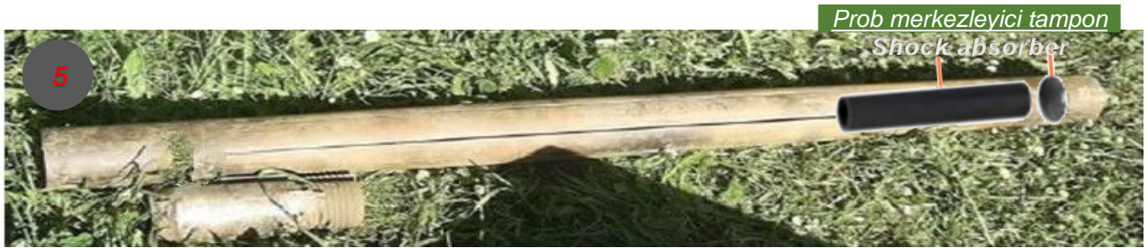
Şekil.21 \phi 75\text{mm} Oluklu-yarıkli muhafaza (slotted tube) borusu [5]
