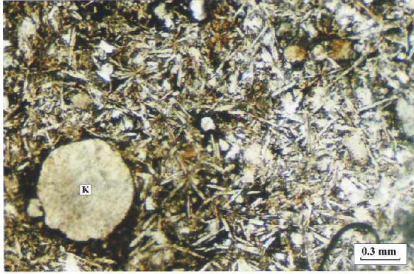
Şekil 6. Tektonik Karmaşık içerisinde yer alan bazaltların genel mikroskobik görünümü, plajiyoklaz mikrolitleri koyu renkli bir hamur içine dağılmış durumdadır K: kalsit, kl: klorit (Tek nikol)
