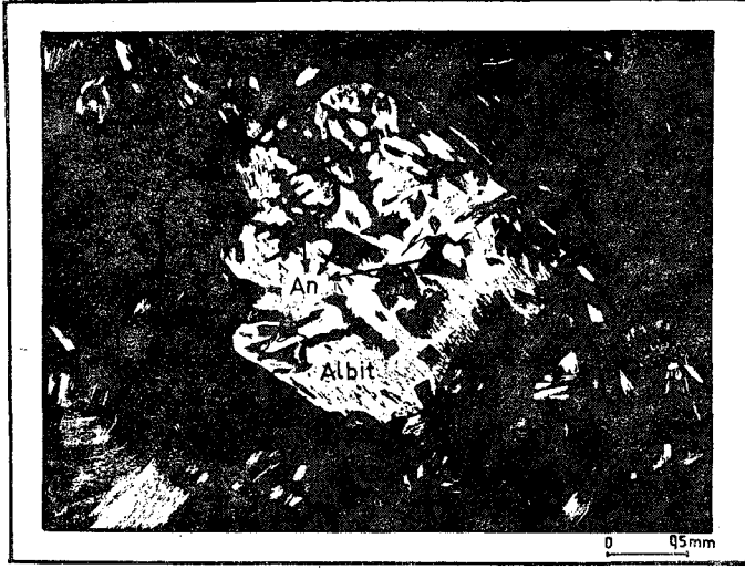
Sekil 3: Albit fenokristali içindeki analsim (An) kalıntıları. Figure 3: Analcime (An) relicts in albite phenocrystal.
