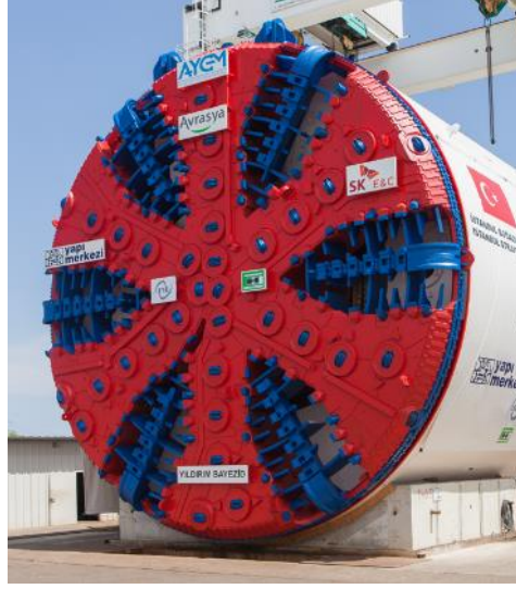
Şekil 1. Boğaz Karayolu Geçişinde Kullanılan Tam Cepheli Tünel Açma Makinesi
