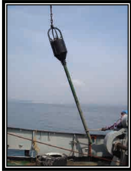
Şekil 1. Çalışma alanı yer bulduru ve batimetri konturlu istasyon yerleri (a), ağırlıklı karot örnek alımından bir görüntü (b).
