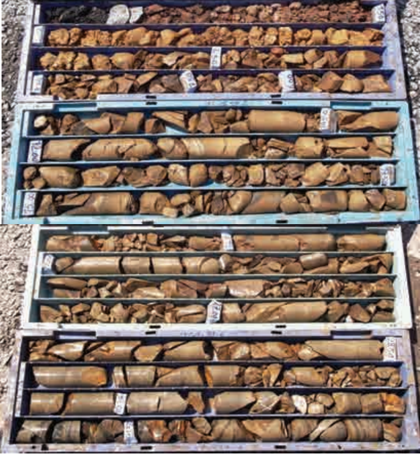
Fotoğraf 1: Trakya formasyonu içerisinde yapılan sondaj çalışmalarında elde edilen karot numune fotoğrafları (Geoteknik A.Ş. Hasköy-Beyoğlu/İstanbul 2012)
