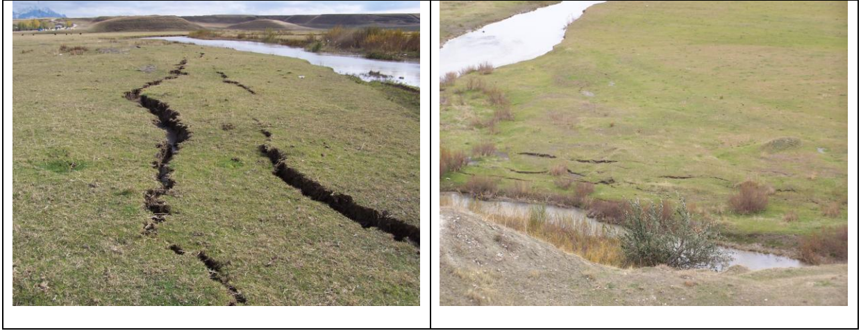
Şekil 14. Topaktaş-Arisu-Dibekdüzü çevresindeki Karasu Çayı boyunca gözlenen yanıl yayılmaya ait arazi fotoğrafları. Soldaki fotoğrafta yanıl yayılma nedeniyle oluşan açık çatlaklar, sağdaki fotoğraf ise akarsuyun menderes yaptığı kavis içinde kalan taşkın düzlüğündeki birbirine paralel çatlaklardan oluşan yanıl yayılmayı göstermektedir.
