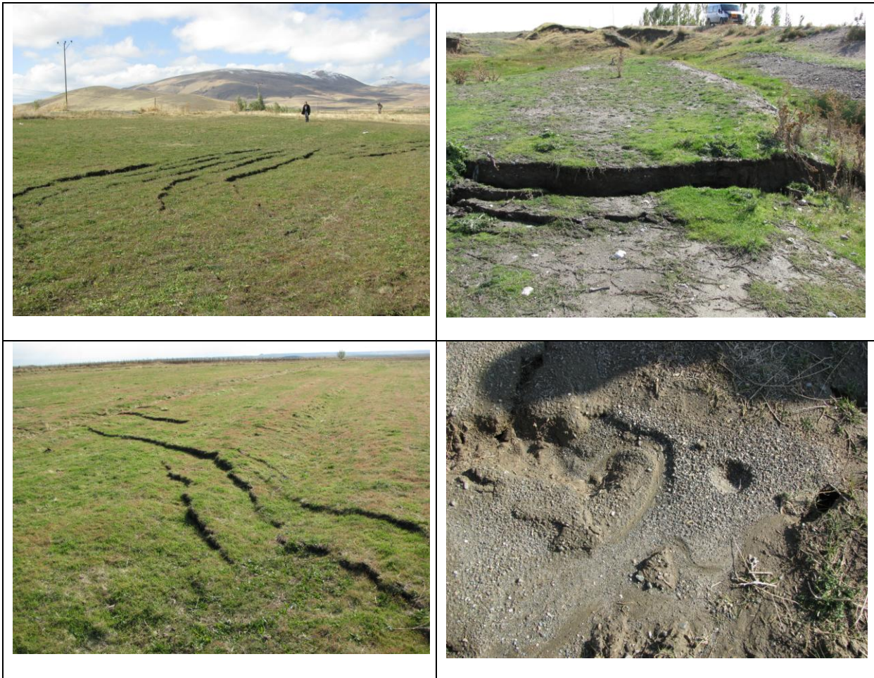
Şekil 12. Göllü ve Alaköy çevresinde gelişen yanıl yayılma ve sıvılaşma yapılarına ait arazi fotoğrafları. Sol üst fotoğrafta gelişen dairesel çatlaklar yüzeye çıkamayan sıvılaşma yapısının varlığına işaret eder. Sol alt fotoğrafta yanıl yönde devamsız ters fay geometrisi sunan yüzey deformasyonları gözlenmektedir. Sağ üst fotoğrafta gelişen normal fay geometrili
