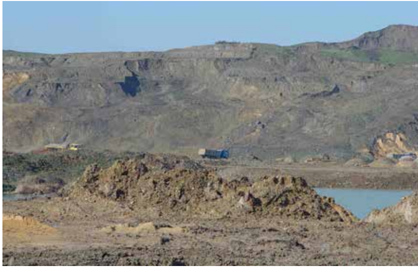
Foto 8. Eski kömür ve kil işletme pasalarının genel özellikleri- düzensiz, bileşimi karışık, gevşek dolgu heyelanlı yapı
