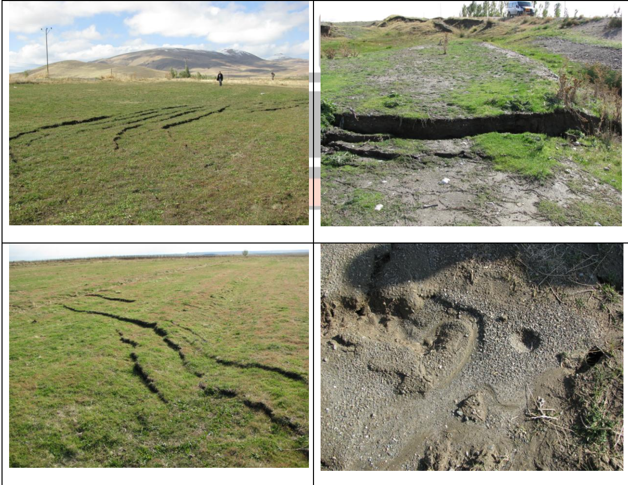
Şekil 12. Göllü ve Alaköy çevresinde gelişen yanal yayılma ve sıvılaşma yapılarına ait arazi fotoğrafları. Sol üst fotoğrafta gelişen dairesel çatlaklar yüzeye çıkamayan sıvılaşma yapısının varlığına işaret eder. Sol alt fotoğrafta yanal yönde devamsız ters fay geometrisi sunan yüzey
