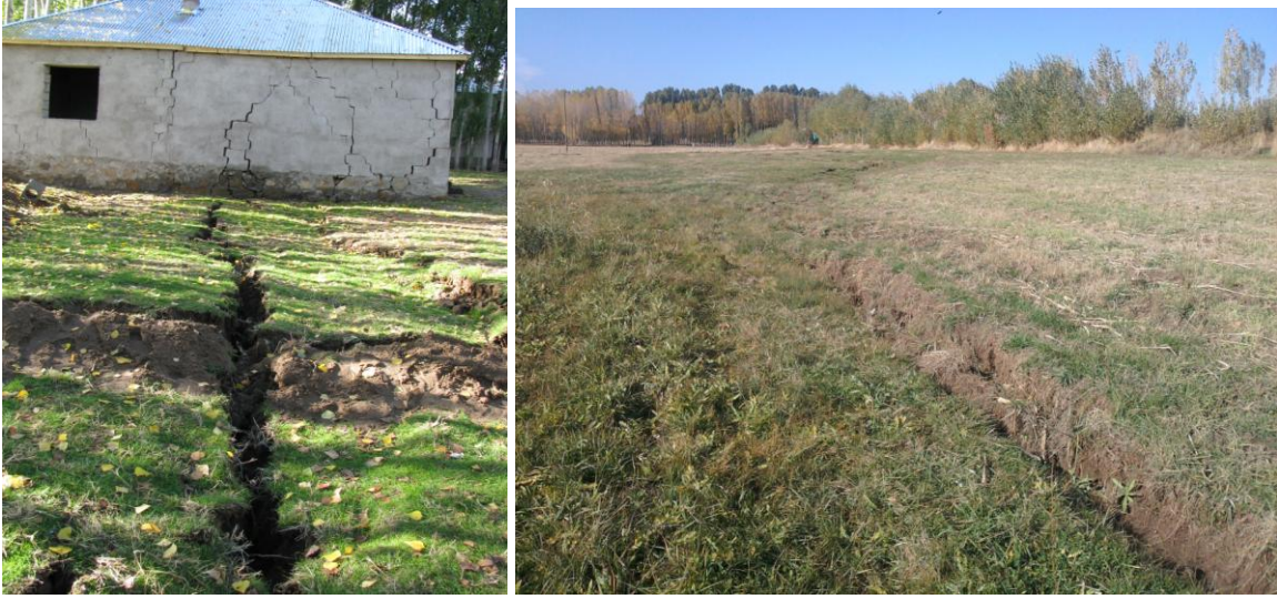
Şekil 31. Erciş-Çelebibağ beldesinde yıkılan hayvan barınağı (sol üstte), yanal yayılmanın yapı üzerinde neden olduğu hasar ve deformasyon (sağ üst ve sol alt), deprem sonucunda oluşan yanal yayılma ve heyelanları (sağ alt) gösteren arazi görüntüleri.
